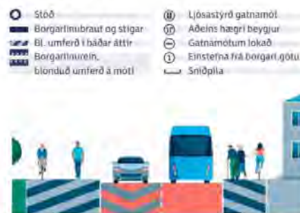
Mynd 2.2 Snið Borgarholtsbrautar milli Þinghólsbrautar og Úrðarbrautar. Einstefna bílaumferðar er í góttunni til vesturs (norðan megin). Gangstétt er breiðari norðan megin. Mynd úr Frumdragaskýrslu Borgarlínunnar.
